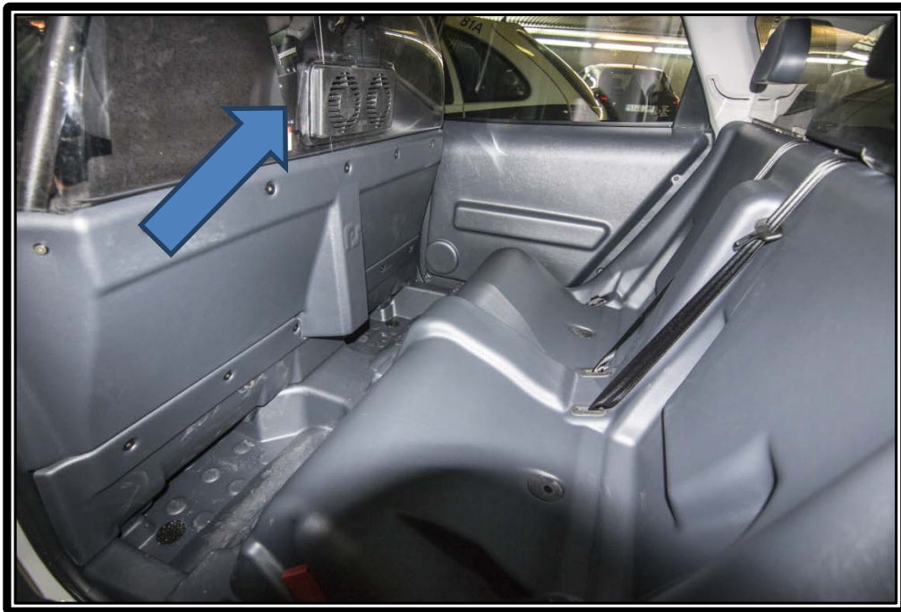
F.7. Plazas traseras. Traslado detenidos. Detalle extractor en mampara
